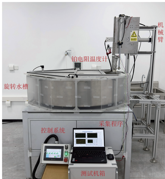
图9 电阻温度计响应时间测试装置
