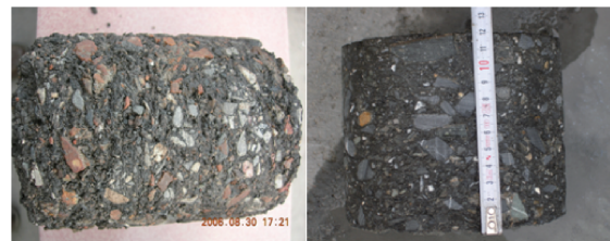
(a) 添加30%二灰材料的芯样 (b) 没有添加半刚性材料的芯样
