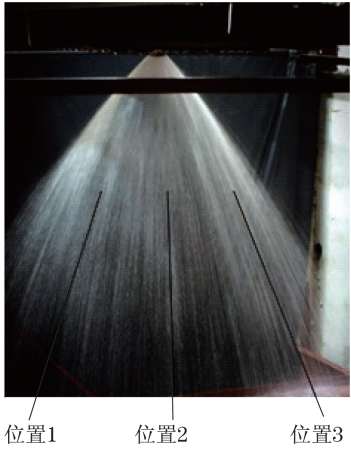
图 6 光学测量位置示意图 Fig.6 Schematic diagram of optical measurement position
