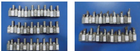
图 4 断口切断不平齐和正断试样
