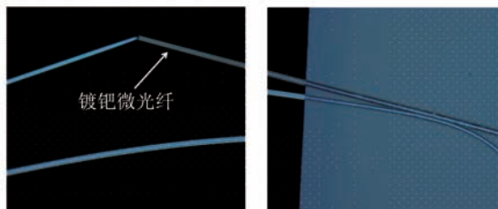
(c) 镀钯微光纤的光学照片 (d) 两根微光纤的光学照片 耦合长度小于 20 \mu\text{m}
