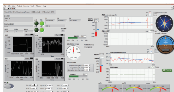
图 6 基于 Labview 的 PID 参数调试图
