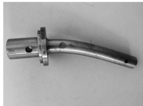
图 6 轴的弯曲破坏情况
