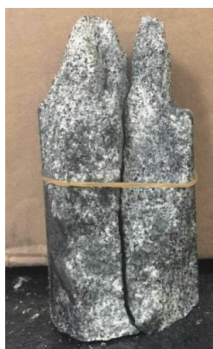
图4 柱状劈裂模式
