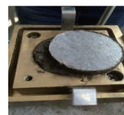
图 4 直剪仪剪切后试样
