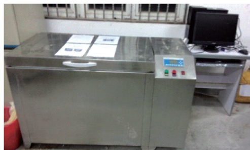
(a) 混凝土快速冻融试验机
