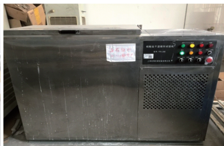
(b) 硫酸盐干湿循环试验机
