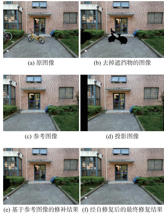
图 7 对图像中遮挡物的修补过程
