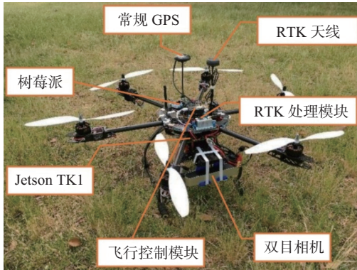
图8 六轴无人机实验平台
