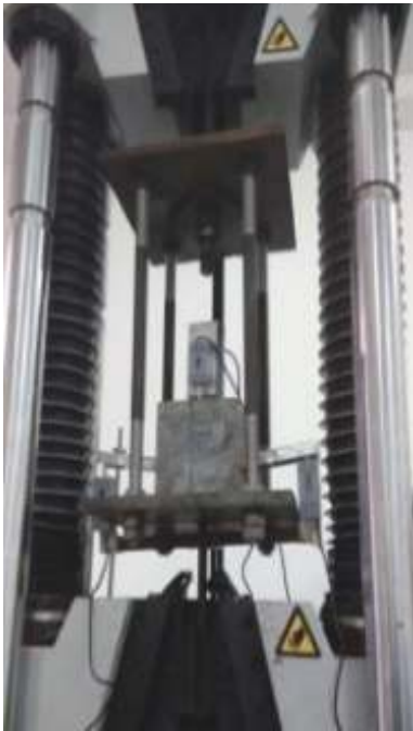
图 2 试验加载装置 Fig.2 Loading appliance
