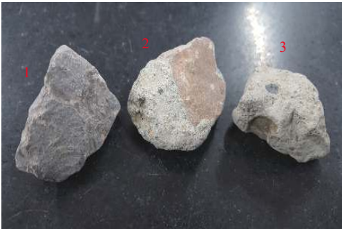
图 2 不同砂浆裹覆量的粒石化再生骨料 Fig.2 Different mortar content of recycled aggregate
