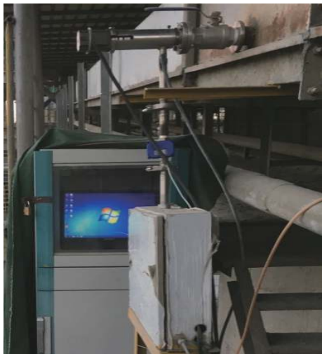
图 5 图像法在线测量系统实物图
