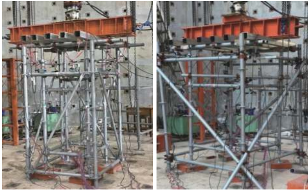
图 5 试验加载图 Fig.5 Test loading
