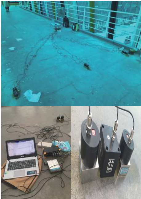
图 11 模态试验现场照片 Fig. 11 Modal test scene photos
