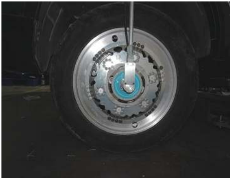
(a) 右后轮六分力测量仪
