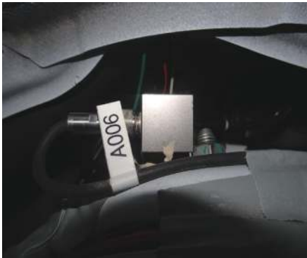
(b) 前减振器安装点三向加速度传感器
