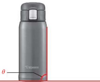
图 8 保温饮水器倾斜角度 \theta 的定义示意图
