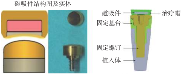
图 3 圆顶型种植体结构 Fig.3 Dome-type implant structure
