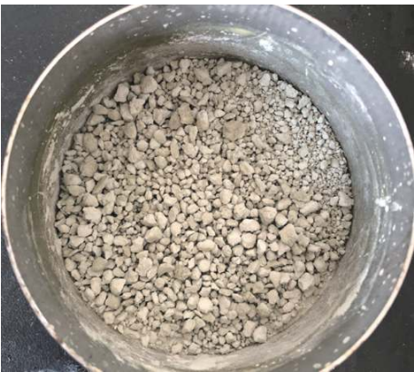
图 5 NMP 结团 Fig. 5 Nonmetal powder agglomerates
