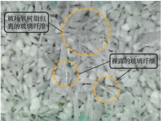
图 1 放大 500 倍的 NMP Fig.1 NMP with 500 times magnification
