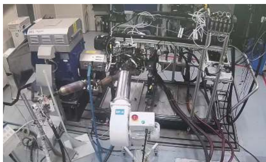
图5 发动机实验台架图
