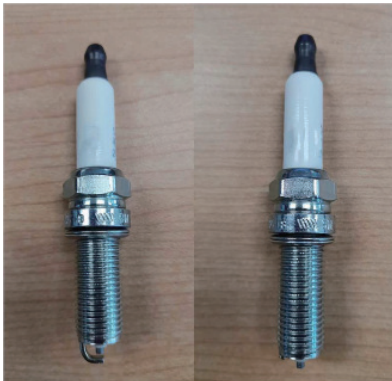
(a) 侧电极火花塞 (b) 无侧电极火花塞
