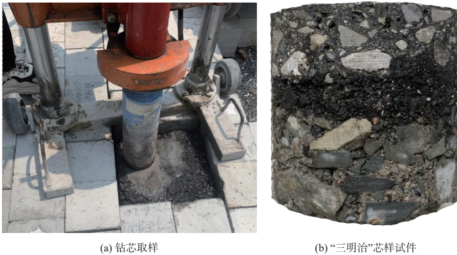
图2 钻芯取样过程及芯样
