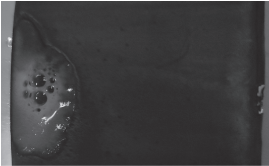
(a) 拆解电池滴水测试
