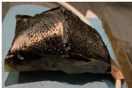
(b) 电池残骸侧面
