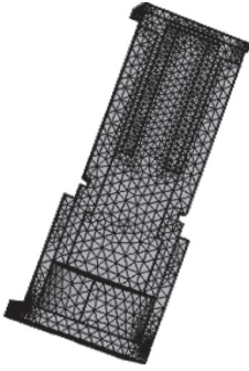
图 3 MRF 辅助装置的网格划分模型
