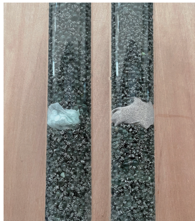
图 2 塔内催化剂填充示意图
