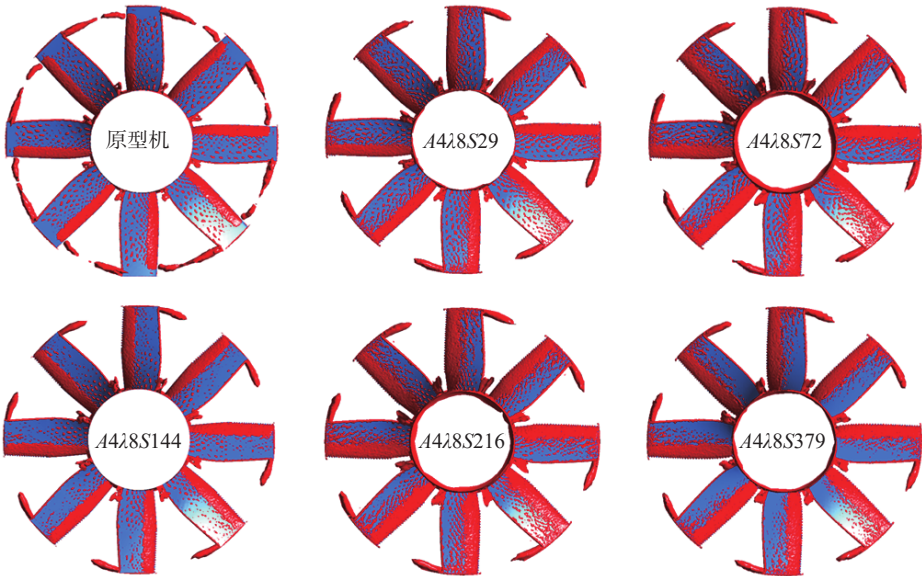
图 23 不同分布长度叶轮的旋涡结构 Fig. 23 Vortex structures of impellers with different distribution lengths
